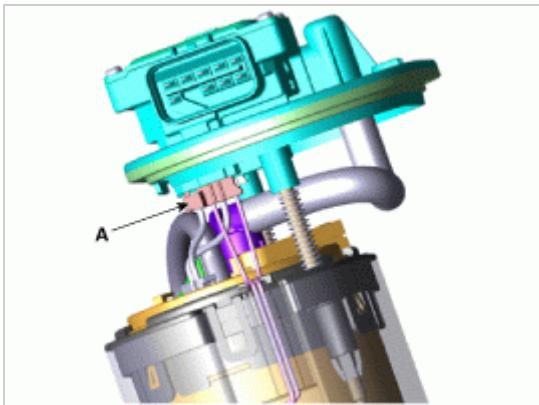
3. 使用通用螺丝刀，举升固定挂钩(A)后，拆卸燃油传感部(B)。
